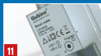
11 Интеллектуальный счетчик электроэнергии (Z-Wave Plus) Smart Meter
