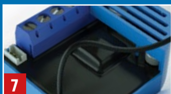
7 Встраиваемый модуль постоянного тока для управления жалюзи (Z-Wave Plus) Flush Shutter DC
