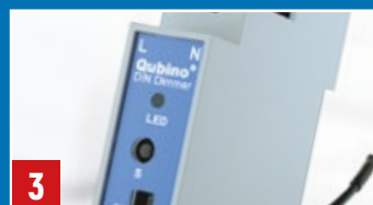
3 Регулятор яркости освещения на DIN-рейку (Z-Wave Plus) DIN Dimmer
